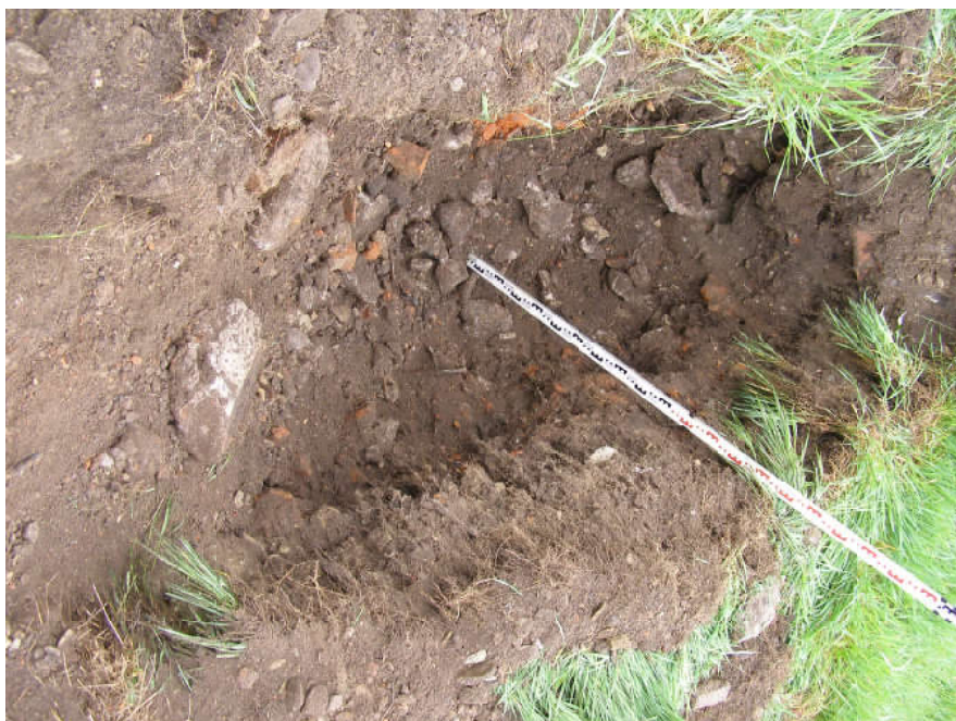
Pohled do strojně kopané sondy SK2 (00,00 - 01,50 m)
